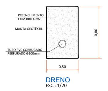
A parte do dispositivo que exerce a função de captação em um sistema de drenagem subterrânea é constituída por tubo dreno, o qual pode ser em polietileno de alta densidade — PEAD, corrugado perfurado, ou em concreto perfurado ou poroso. A parte da canalização que exerce a função de condução, a partir do conjunto de captação até o deságüe, é constituída por condutores não perfurados de concreto.
