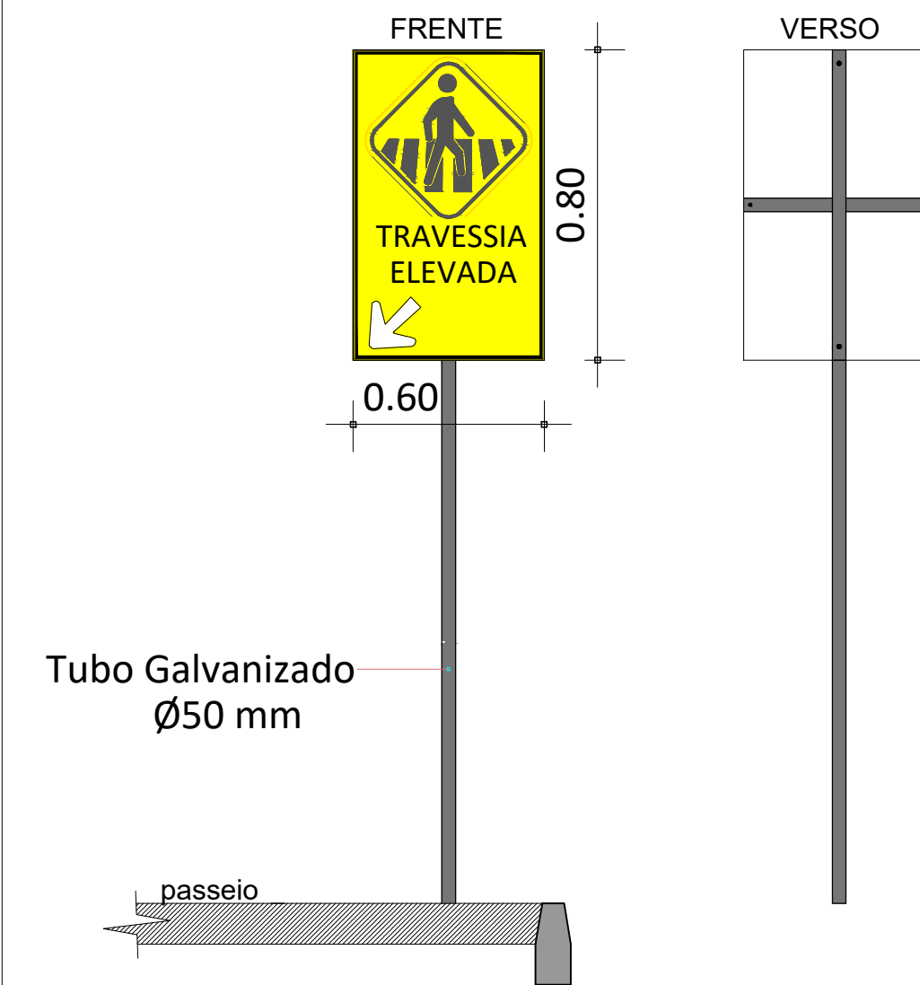
VISTA - PLACA TRAVESSIA ELEVADA ESC: 1/25
