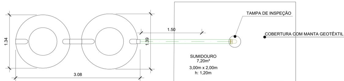
PLANTA BAIXA-SISTEMA DE TRATAMENTO DE ESGOTO
