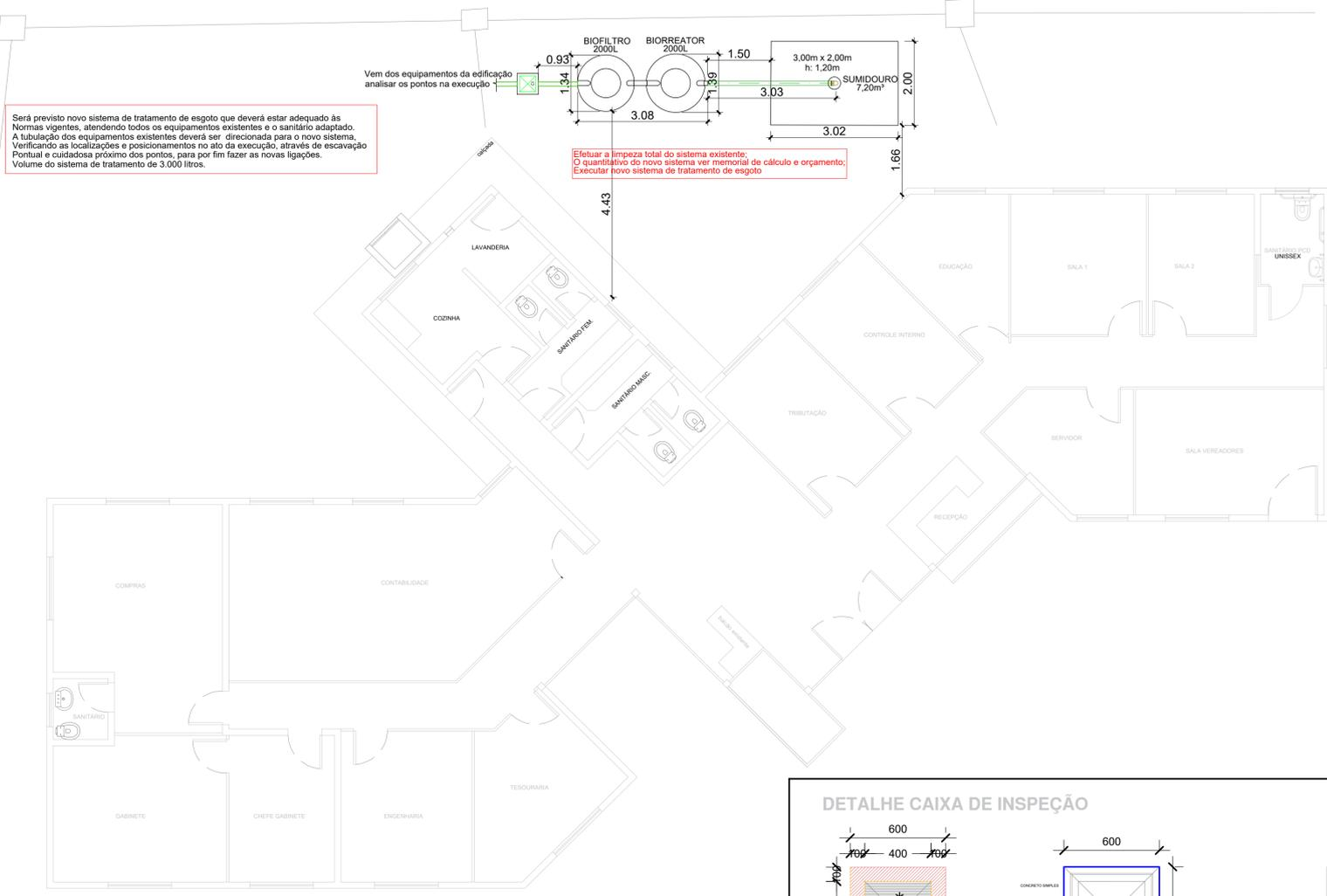
Será previsto novo sistema de tratamento de esgoto que deverá estar adequado às Normas vigentes, atendendo todos os equipamentos existentes e o sanitário adaptado. A tubulação dos equipamentos existentes deverá ser direcionada para o novo sistema. Verificando as localizações e posicionamentos no ato da execução, através de escavação Pontual e cuidadosa próximo dos pontos, para por fim fazer as novas ligações. Volume do sistema de tratamento de 3.000 litros.
