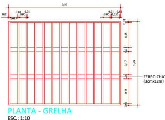
Deverá ser previsto um colarinho de concreto com espessura de 10 cm, e a colocação da grade de ferro na alvenaria com uma cantoneira em ferro conforme detalhe apresentado.
