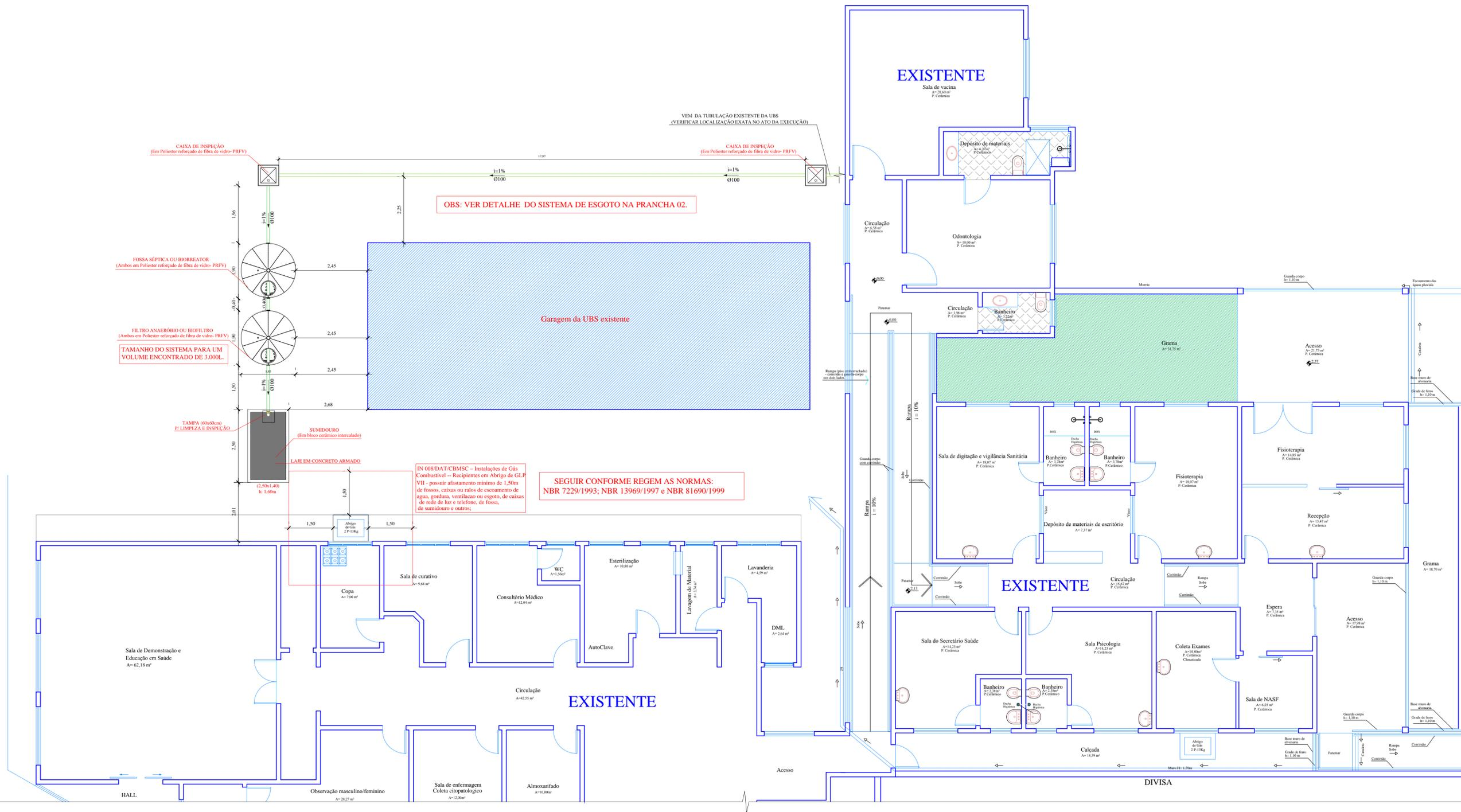
PLANTA BAIXA-SISTEMA DE TRATAMENTO DE ESGOTO
